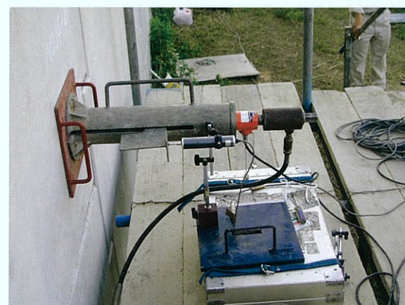
【幅広ストリップの引抜き試験状況】
